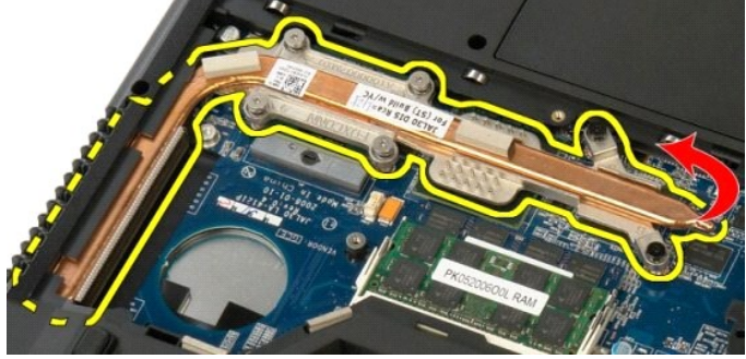
7. إسحب وحدة امتصاص الحرارة باتجاه وسط الكمبيوتر، ثم ارفعها وقم بإزالتها من الكمبيوتر.
