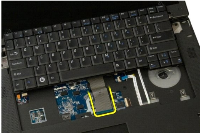
8. قم بإزالة لوحة المفاتيح من الكمبيوتر.
