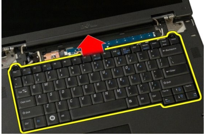
6. افتح مثبت كبل بيانات لوحة المفاتيح لتحرير الشريط.
