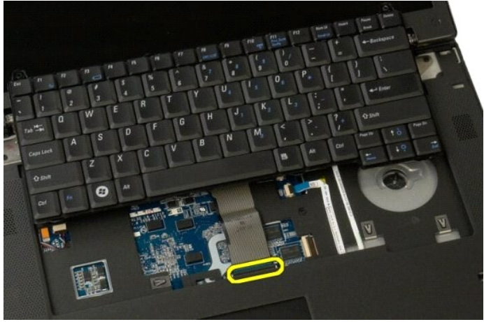
7. انفصل كبل بيانات لوحة المفاتيح عن المثبت.
