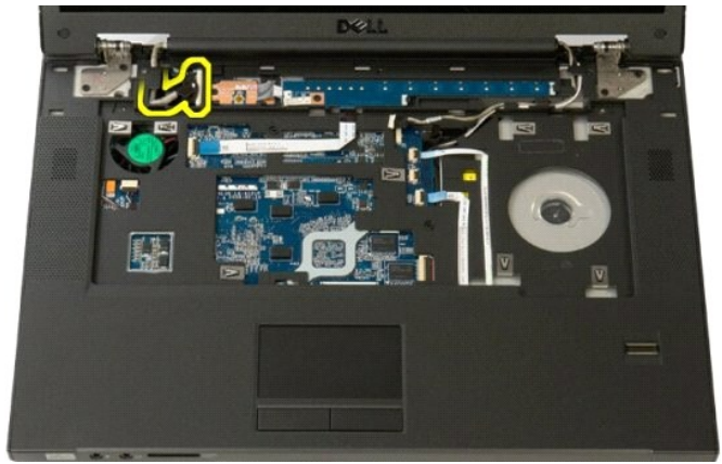
11. اسحب كبلات الهوائي عبر لوحة النظام بحذر.
