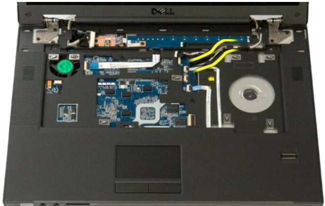
21. قم بإزالة كبلات الهوائي من فتحات الكبلات الخاصة بها.
